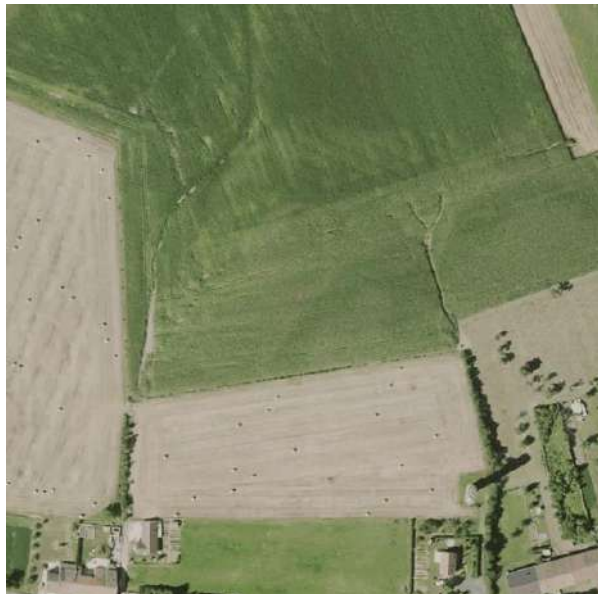
Fig. 99. Ravines créées suite à des ruissellements importants, Villers-Stoncourt
