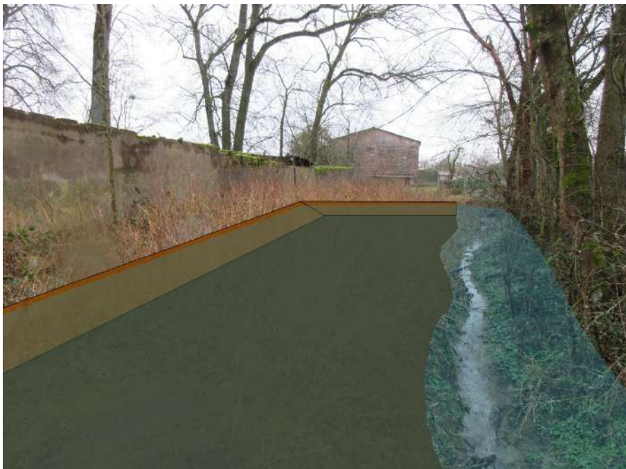
Fig. 53. Déblaiement du lit majeur rive droite du cours d'eau, Maizeroy
