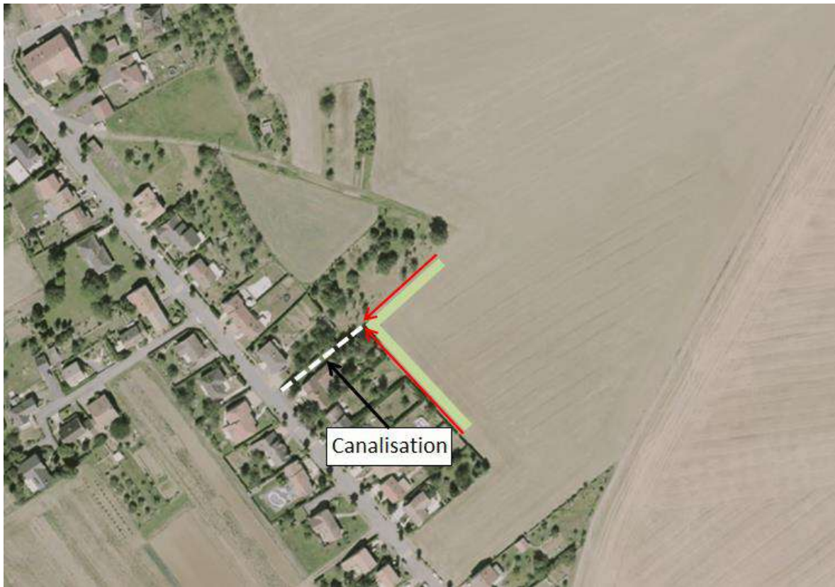
Fig. 92. Canalisation à créer BVn°1, Servigny-les-Saintes-Barbes
