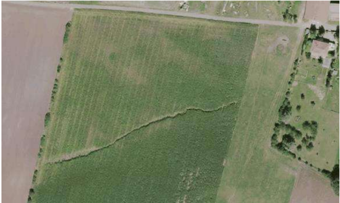
Fig. 27. Ravine créé par les ruissellements en amont de MUssy-l'Evêque et visible sur les photographies aériennes
